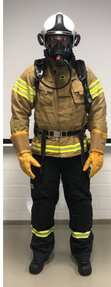
Kuva 5. Pitkäaikaiseen altistumiseen tarkoitetut suojarusteet, Pelastajan suojarusteet.
