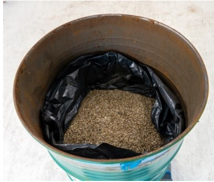
Kuva 3. Tynnyrissä olevaa vermikuliittia akkujen lähetyksestä varten.
