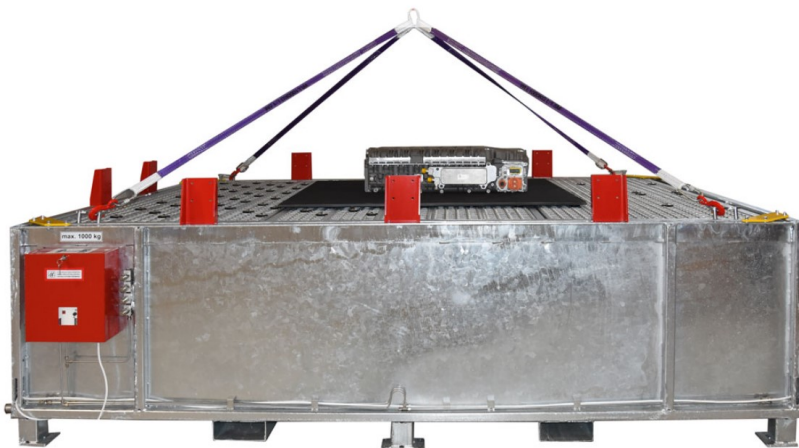
Kuva 1. Akkujen asennuspöytä, joka mahdollistaa akun upottamisen palotilanteessa manuaalisesti tai automaattisesti.
