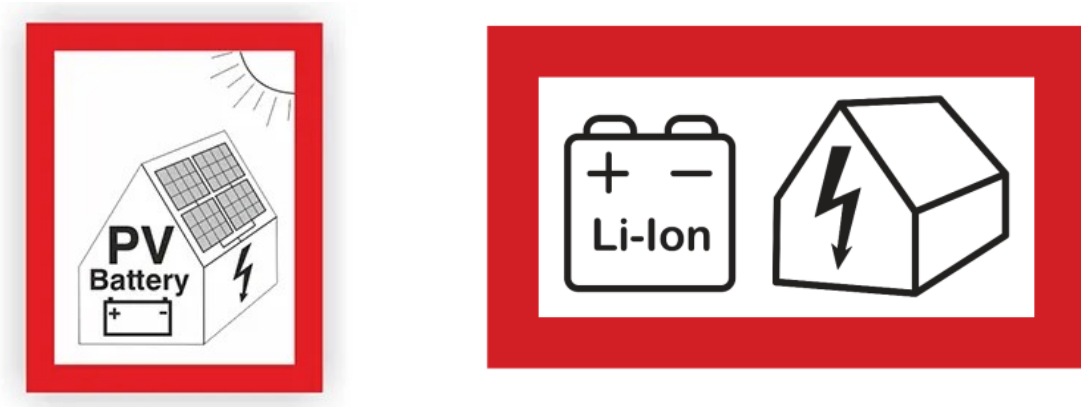
Kuva 1. Esimerkkikuvat aurinkosähkö- ja akkujärjestelmästä ilmoittavasta merkistä.
